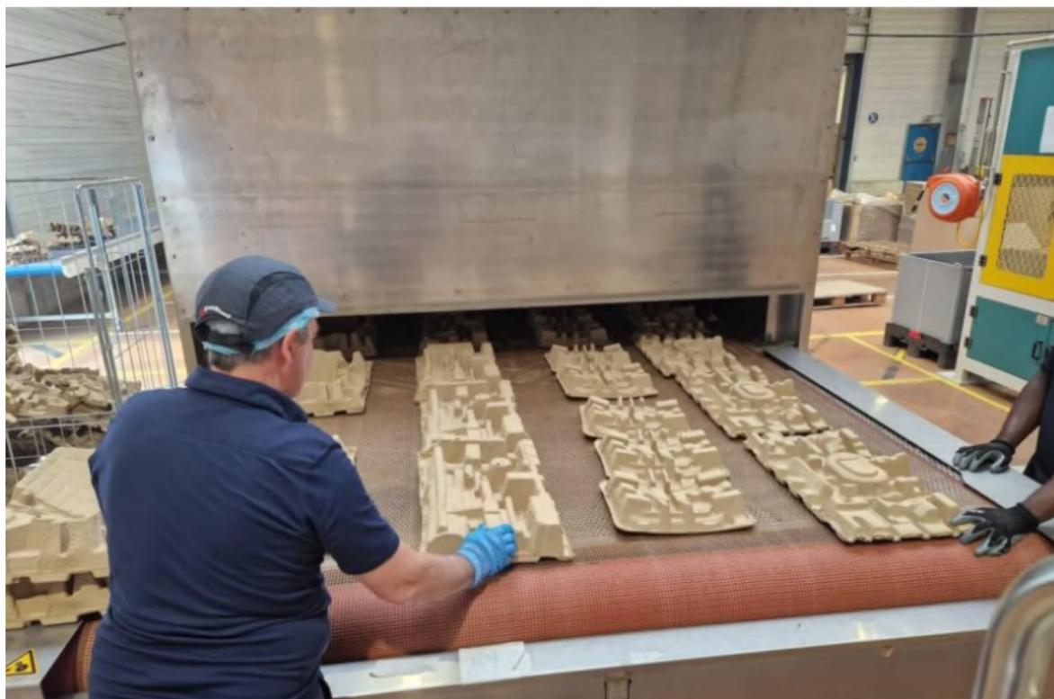
Une alternative durable aux emballages en polystyrène expansé, c'est ce que propose l'entreprise bretonne Écofeutre, qui vient d'inaugurer en mars dernier une nouvelle ligne de production de fabrication de produits en papiers/cartons, à partir de matière recyclée. Ce projet de recyclage, mené avec le soutien de l'ADEME, va lui permettre de s'ouvrir à de nouveaux marchés en développant des pièces de calages industriels résistants, tout en réduisant son impact environnemental.
