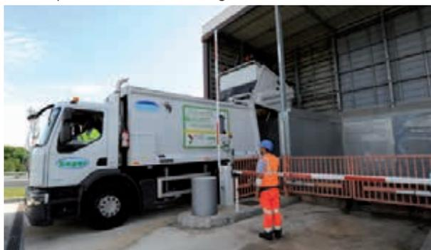
Les quais de transfert permettent de charger le contenu des camions de collecte dans des camions de plus grande capacité qui sont orientés vers des équipements de tri ou de traitement de déchets éloignés des lieux de collecte.
