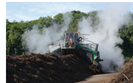
/ l'enjambeur en cours de retournement des andains sur la plateforme de Réau /
