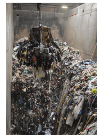
/ Le grappin dans la fosse à déchets en charge d'alimenter les fours /
