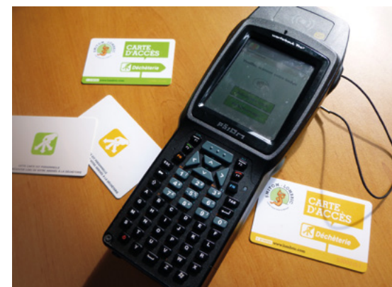
/ le terminal mobile et les cartes d'accès en déchèterie développés dans le cadre de la refonte du système de gestion des accès /
