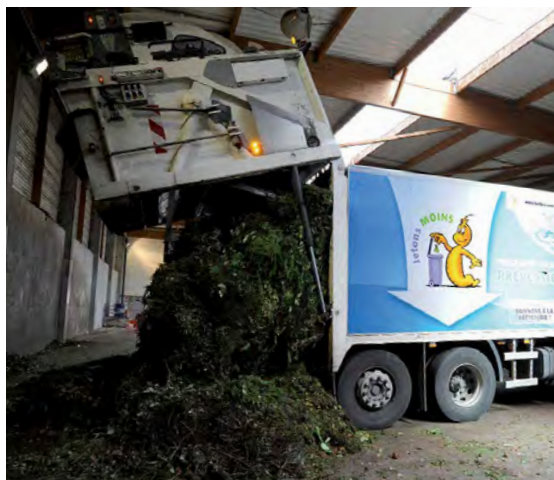
→ déchargement des déchets verts sur la plateforme de compostage de Réau
